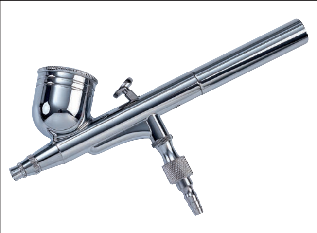
Dual-action airbrush Aerografo dual-action Dual-action flow regulator. Nozzle ø 0,3 mm, capacity 7 cc. Regolatore di flusso a doppia azione. ø ugello 0,3 mm, capacità 7 cc.
